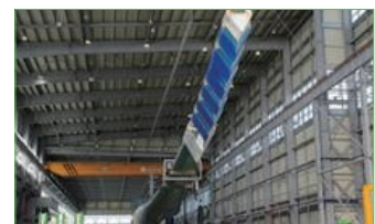
[ 5.5MW급 풍력 블레이드 플랩 피로시험 (신규시험동) ]
