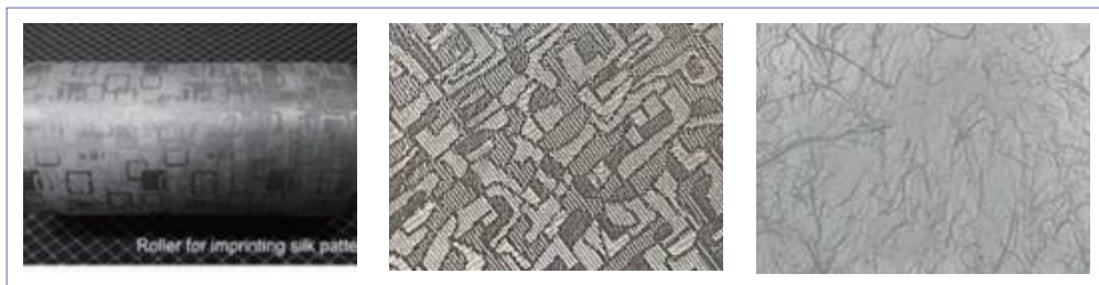
[전주 도금법에 의해 복제된 (좌)원통형 전주 몰드와 Al Sheet 표면에 전사된 복제된 (중)실크 및 (우)한지 소재 촉감]
