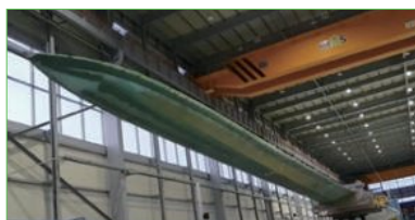
[ 5.5MW급 풍력 블레이드 엷지 피로시험 (구시험동) ]
