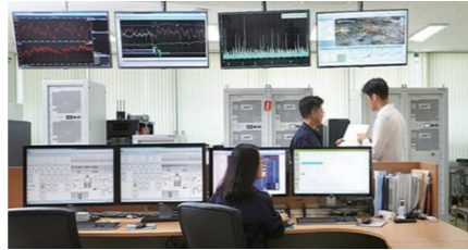
300kVA급 마이크로그리드 실시간 디지털 시뮬레이션 시스템
