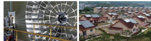
400kWt급 KIER 태양로 (바이오메탄 분해 수소생산 실험)
